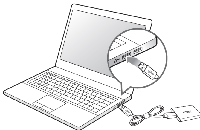
C till A-kabel
